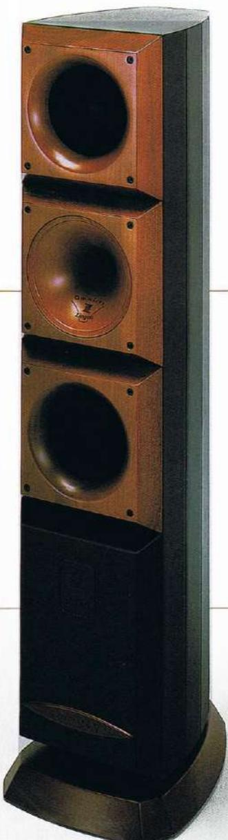
採用されているオムニレイホーンは、無垢のイエローボーラのブロックを切削加工して独自の形状に仕上げたもの。表面がじつになめらかで美しい。深いスローと浅いホーンを組み合せて360度の円形放射バターンと140度の拡散角度(水平／垂直)を持たせている。この設計の狙いは、リスニングエリアを広げ、音場感を向上させ、巷間取り沙汰されるホーンくささ(鼻音効果)から逃れるためだろう。
